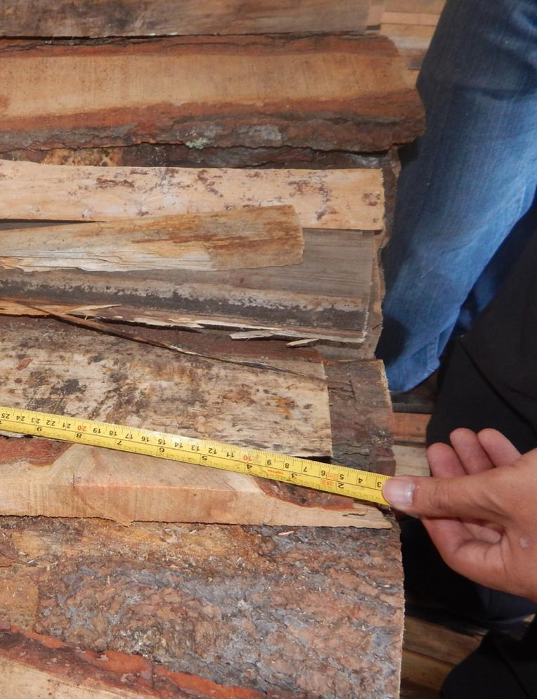
**Figura 16. Medición para la estimación de volumen de lepa.**
